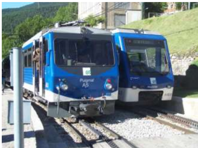
croisement à Queralps, le seul évitement de la ligne
