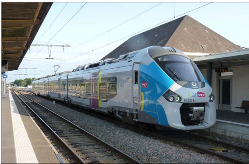
Le B 84539 sur « le train des plages » en gare de Saumur le 8 juillet 2015. Le panto est levé, l'engin est en mode électrique.
