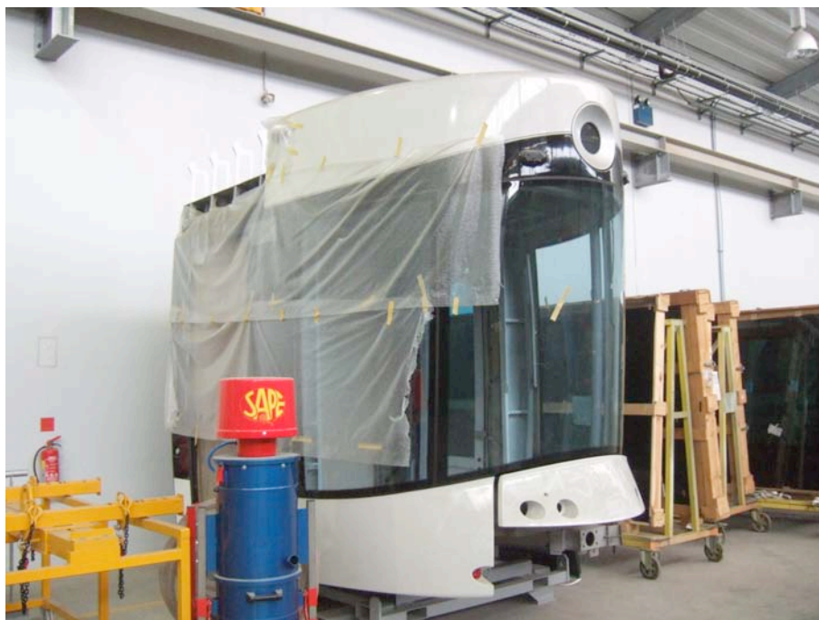
Un ensemble complet en réserve : carrosserie en fibre de verre + vitre polycarbonate
