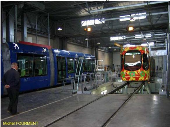
Dans l'atelier, rame hirondelles , bleue , ligne 1 et au reprofilage des roues sur le tour en fosse , une rame fleurs de la ligne 2 .
