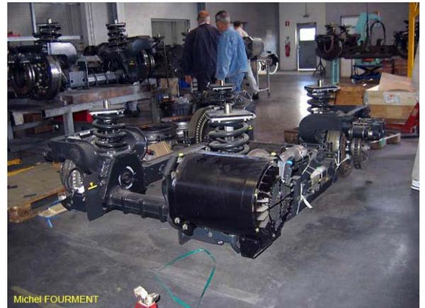
Bogie moteur surbaissé , permettant le plancher bas sur toute la longueur de la rame
