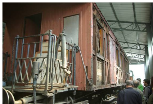
Voiture voyageurs en cours de restauration.
