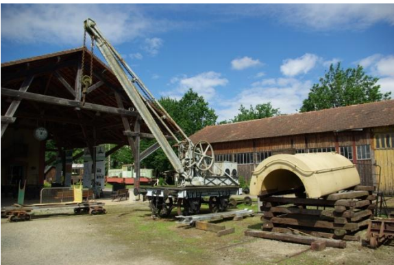
La grue roulante et le bac d'eau de la locomotive 020 T Alice en cours de restauration
