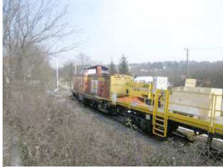
Les trains de travaux sont tractés par des locomotives d'origine allemande Type V 100 puis 211 ou 212 à la DB et maintenant chez COLAS RAIL
