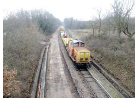
Les trains de travaux sont tractés par des locomotives d'origine allemande Type V 100 puis 211 ou 212 à la DB et maintenant chez COLAS RAIL
