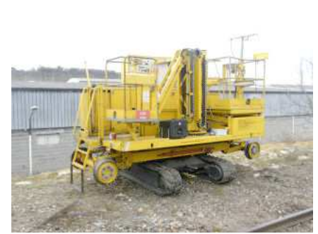
Engin nacelle pour la pose des caténaies.
