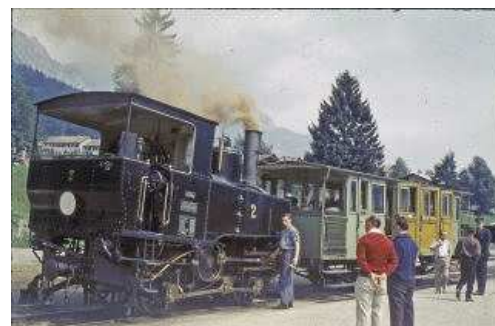
L'AchenseeBahn. Locomotive 020 T Voie métrique à crémaillère type Riggenbach Rampe maximum 160 ‰. Rampe moyenne 130 ‰.
