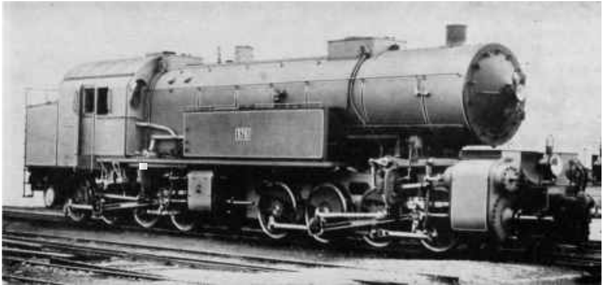
Figure 1 - Locomotive-tender Mallet, type 4 + 4 à surchauffeur des chemins de fer bavarois. La plus puissante d'Europe sous le rapport effort de traction. (Photo Krauss-Mafféi)
