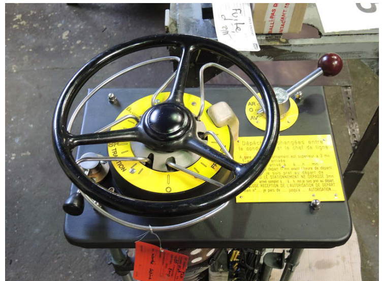
Manipulateur de traction prêt à reprendre sa place.
