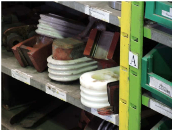
Isolateurs : ceux de gauche d'origine sont en porcelaine ; celui de droite est une pièce générique, donc à l'identique mais en matière composite moderne.
