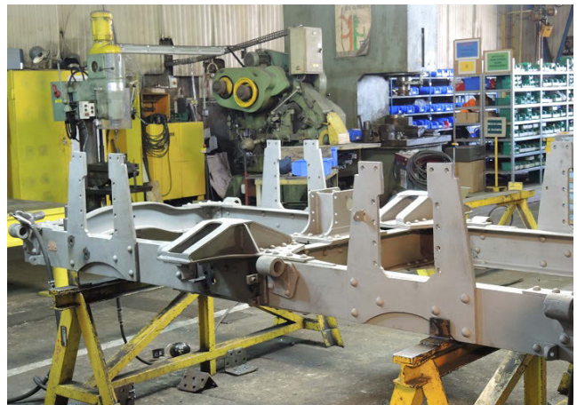
Un châssis de bogie de motrice (retourné) peut comprendre aussi bien des pièces d'origine que des pièces génériques (l'acier employé aujourd'hui est de meilleure qualité). L'assemblage des divers éléments se fait comme à l'origine par rivetage.
