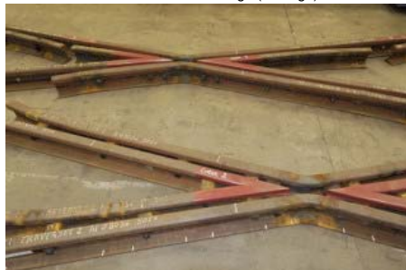
Traversée pour 2 voies d'écartement différents (1 métrique et 1 normale)
