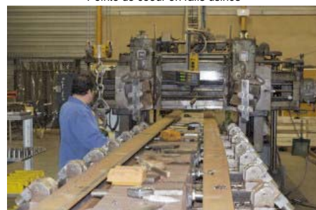
Rails en cours d'usinage (robotage)
