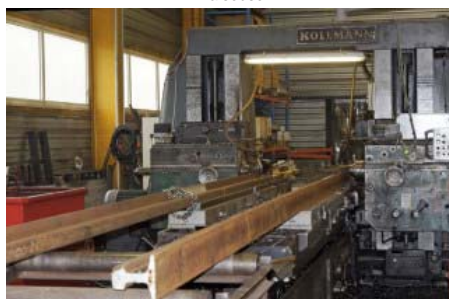
Rails en cours d'usinage (fraisage)
