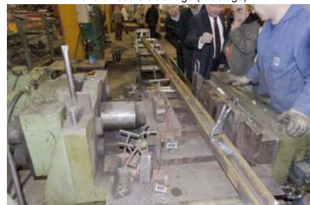
Dressage à la presse d'un 3ème rail pour le métro du Caire
